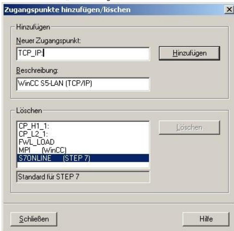
7. Dieser Dialog bietet Ihnen die Möglichkeit einen neuen Zugangspunkt hinzuzufügen. Geben Sie dem neuen Zugangspunkt den Namen „TCP\_IP:“ und eine beliebige Beschreibung (z.B. „WinCC S5-LAN++(TCP/IP)“). Klicken Sie auf „Hinzufügen“ und „Schließen“ Sie anschließend den Dialog.
