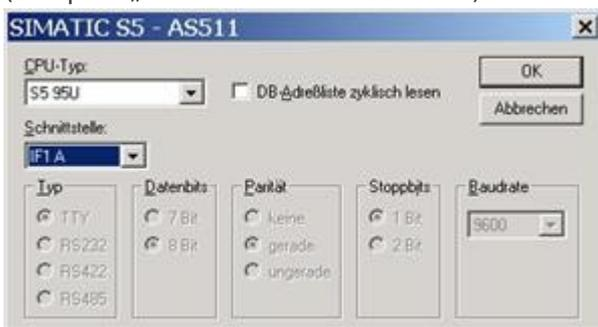
5. Über „Parameter...“ rufen Sie einen Einstellungsdialog für die ausgewählte SPS auf. Wählen Sie den verwendeten „CPU-Typ“ und die „Schnittstelle“ an der das Terminal verbunden ist (im Beispiel „IF1 A“). Des Weiteren konfigurieren Sie die Parameter der Schnittstelle („Typ“, „Datenbits“, „Parität“, „Stoppbits“, „Baudrate“).
