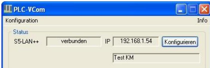
6. Im Hauptfenster des PLC-VCOMs erscheint nach einem erfolgreichen Verbindungsaufbau, der Kabeltype mit dem sich der Computer verbindet, der Verbindungsstatus „verbunden“, die IP-Adresse und der Name des verbundenen Teilnehmers.
