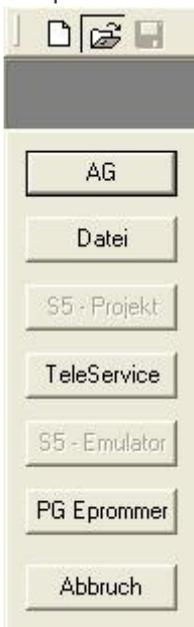
6. Jetzt ist die Software bereit eine Verbindung zu der SPS herzustellen. Klicken Sie dazu auf das Symbol „Öffnen“ und danach auf die Schaltfläche „AG“. Alternativ über das Menü: „Datei“ ⇒ „Öffnen“ ⇒ „AG“
