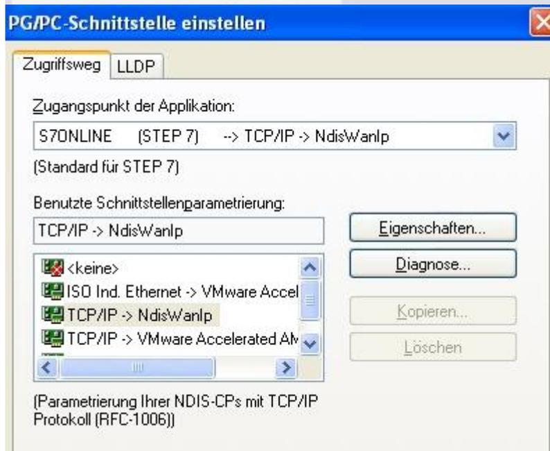
3. Beachten Sie, dass der Zugangspunkt (S7ONLINE) richtig eingestellt ist. Die Einstellung nehmen Sie in der Systemsteuerung unter "PG/PC-Schnittstelle einstellen" vor. Achten Sie darauf, dass ein Adapter mit TCP/IP-Unterstützung ausgewählt ist.
